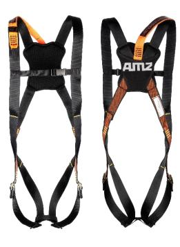
O modelo **C100** pertence a linha C de Cintos da AMZ. Cinturão para trabalhos em altura. Possui elemento de engate de retenção de queda "A" dorsal nas versões curto ou com extensor. Regulável através de 2 pares de fivelas ou 3 pares nas versões com cintura. Pode ser fornecido com metálicos em aço carbono, aço inox, dielétricos ou com fivelas automáticas.
